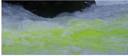
Figure 2 : trace de produit fluorescent (traceur)
