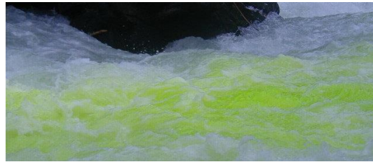
Abbildung 2: Farbstoffspur einer Fluoreszenz-Tracermessung.
